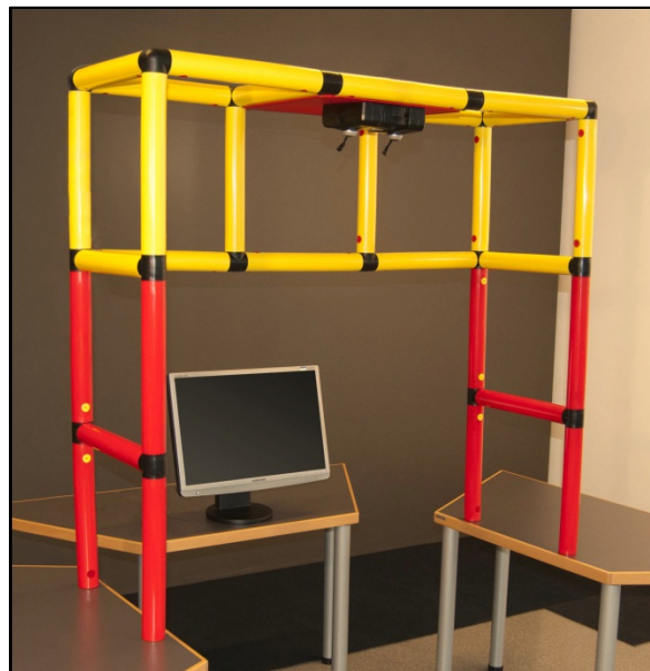
Abbildung 3: Überkopfinstallation der Motiontrackinghardware
